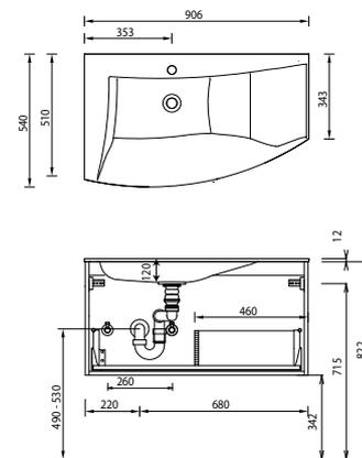
Bei Waschtischanlagen mit Befestigungsschrauben müssen die Maße zum Bohren vor Ort, nach dem Auflegen des Waschtisches auf den Unterschrank, angezeichnet werden.
