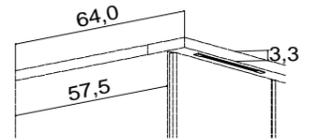
Für den Aufbau in einer Nische benötigen Sie mind. 3 cm Luft in der Breite und 2 cm Luft zur Decke.
