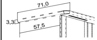
Für den Aufbau in einer Nische benötigen Sie mind. 3 cm Luft in der Breite und 2 cm Luft zur Decke.
