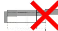
Ein Einsetzen des Universalstützfußes ist aus konstruktionsgründen ebenfalls nicht möglich.
